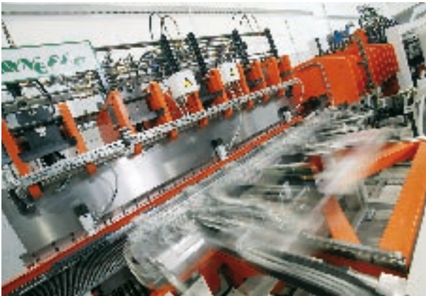
Die Spiegelseite rechts mit einer eventuellen Schattennut wird komplett in der dritten Biegestation abgebogen. Die letzte Biegestation macht das Selbe für die linke Spiegelseite.
