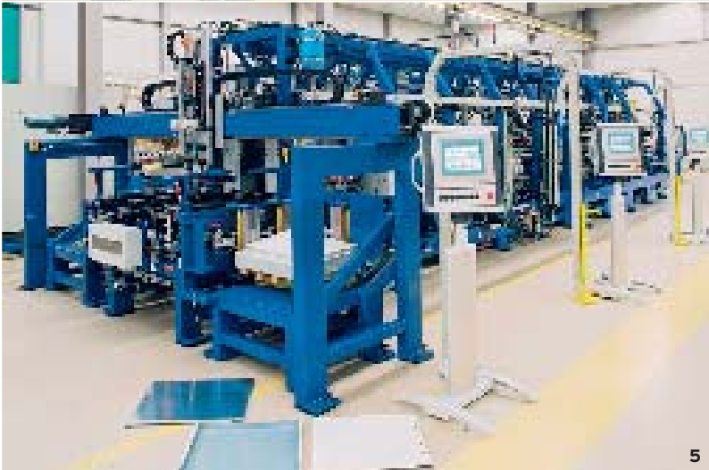
2 _ Niederländische Alternative: Bei Wemo entstand eine Anlage, die kratzerfrei Edelstahlbleche ohne Folie bearbeitet. 4 _ Kombination: Diese Maschine stanzt, biegt und schweißt Schlauchkästen. 5 _ Weiße Ware: Polierte Balken sowie die geringe Relativbewegung zwischen Werkzeug und Produkt verhindern bei dieser Anlage zur Produktion von Seitenwänden für Geschirrspüler, dass das vorlackierte Material verkratzt wird. (Maschinenbilder: Wemo)
